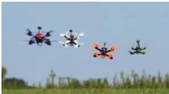
В дрон-рейсинге существует ограничение: расстояние между роторами диаметрально противоположных моторов не должно превышать установленного значения. Наиболее популярные классы дронов – от 210 до 250 мм. Количество моторов обычно не регламентируется, но почти все пилоты летают на квадрокоптерах – это оптимальное решение с точки зрения мощности, веса и аэродинамики. При этом время полёта гоночных дронов невелико и в среднем составляет 3–5 минут.
